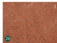
Brick dust is used in lime mortar. Debu batu-bata digunakan dalam mortar kapur. 磚碎粉應用於白灰沙漿。
