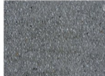
Granite chippings in Shanghai plaster. Cebisan granit pada lepaan Shanghai. 洗石子内的花岗岩粒。
